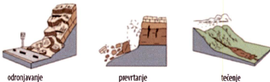
Slika 27.: Prikaz osnovnih tipova klizanja prema mehanizmu kretanja
