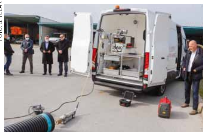
Opremljeno kamerama i laserom za snimanje odvodnih cijevi - prvo od tri specijalizirana vozila koja je Ivkomu stiglo iz EU fondova
