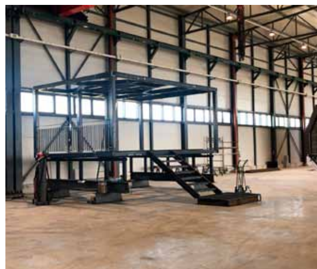
Konstrukcija je gotova i pripremljena za pocinčavanje
